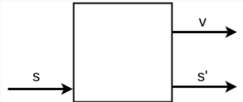
Figure 1: Transformador de estado
